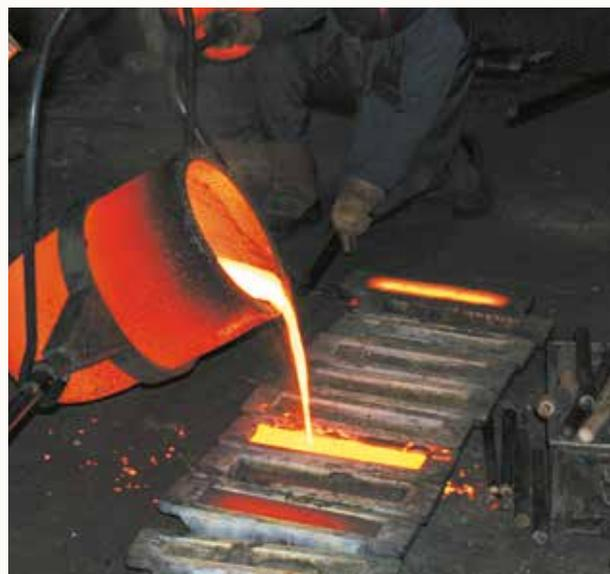
Kran direkt in die bereitstehenden Sandgussformen gefüllt. Bis zu 280 Formen können pro Tag befüllt werden.
